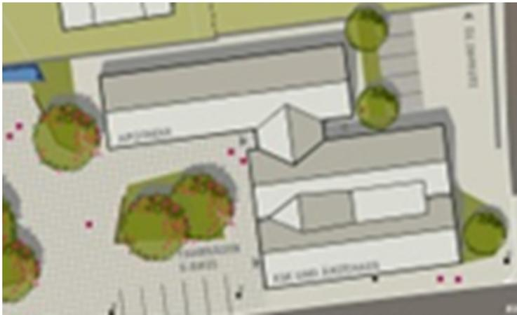
Das Wohnhaus umfasst 6 Wohnungen, wird, mit Ausnahme des Aufzugsschachtes, in sehr hochwertiger Holzständerbauweise ausgeführt und entspricht einem KfW 55 Standard. Wie das Ärztehaus wird auch das Wohnhaus an das Nahwärmenetz der Gemeinde angeschlossen.
