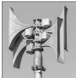
Elektrische Sirenen erzeugen den Ton mit einem Lautsprecher und einem elektronischen Verstärker. Mit einer Steuerung kann man ebenfalls das Auf- und Abschwelen der mechanischen Sirene nachempfinden. Vorteil der elektronischen Sirenen ist, dass sie über keine beweglichen Teile verfügen. Somit verringert sich das Gewicht, Wartungsaufwand und Stromverbrauch.
