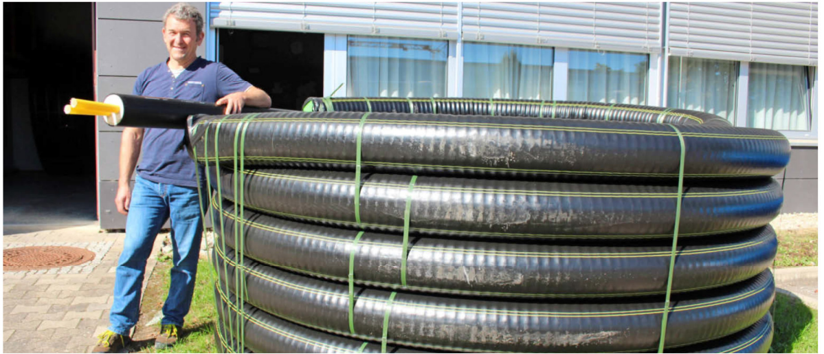
Thomas Gessler von der Ilsfelder Verwaltung zeigt, wie die neuen Rohre aussehen, die künftig die Wärme in die Ilsfelder Haushalte liefern.
